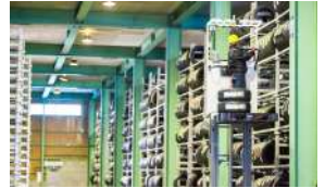
天井高 7m を有効利用可能な専用ラックとピッカー
